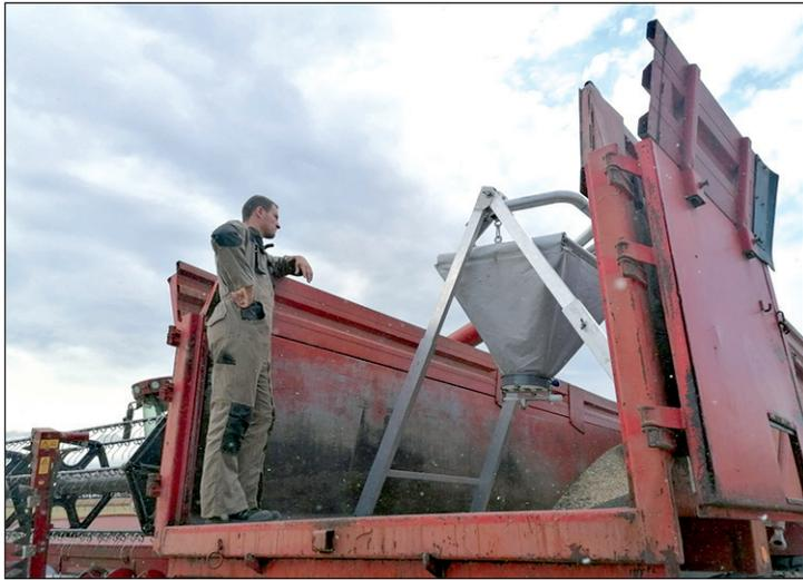
Récolte d'essais grâce à un peson mis à l'arrière d'une benne.
